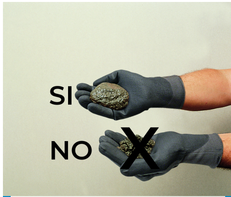
Détermination de la consistance adéquate du mélange Mapecem
