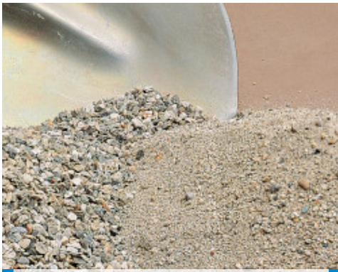
Granulats pour chape Mapecem sable de 0 à 4 mm - gravillon de 4 à 8 mm
