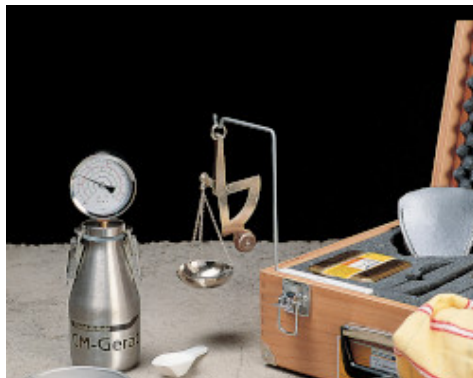
Metten van vocht in Mapecem dekvloeren met een carbid hygrometer
