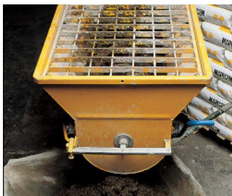
Mapecem gemengd in een kleine betonmolen
