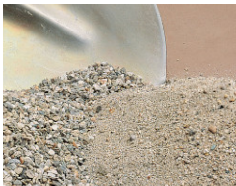
Toeslagmateriaal voor Mapecem; grind van 4 tot 8 mm - zand van 0 tot 4 mm
